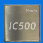
利尔达IC500工控核心板基于高性能Freescale I.MX6ULL系列处理器设计,处理器采用Cortex-A7内核,最高主频可达792MHz,具有丰富的外设资源,集成LCD控制器,分辨率高达WXGA(1366x768),支持USB2.0 OTG,10/100MHz以太网,支持CSI,QSPI,CAN,UART,ADC,MMC/SDIO,定时器/PWM,SPI,I2C,I2S/SAI,S/PDIF等外设接口。广泛适用于各类工业人机界面、IoT网关、便携医疗设备、智能控制系统等应用场景。
