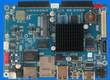
利尔达IM600工控主板基于飞思卡尔i.MX6系列处理器设计，处理器采用Cortex-A9内核，集成了高速DDR存储器和大容量eMMC存储器，引出常用外部接口包括：耳机输出，HDMI，USBOTG，USBHOST，千兆以太网，SIM卡座，MicroSD卡座，DC接口，SATA接口等，Wi-Fi模块，RTC，支持板载4G模块。为了提高主板通用性，同时具有扩展接口，使用不同的扩展板可以满足不同功能需求。具有集成度高，扩展性强的特点。软件方面提供完善的OS和丰富的外设驱动支持，可以提升用户开发效率，降低开发，生产成本，可广泛适用于各类工业应用场景。
