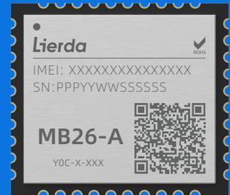
利尔达MB26-A Y0C系列模组基于移芯EC626平台，其尺寸仅为17.7\*15.8\*2.2mm，可满足终端设备对超小尺寸模块产品的需求。采用LCC封装，方便客户焊接，实现过标准SMT设备实现模块的快速生产。MB26-A Y0C系列在封装设计上兼容MB26-S Y0C系列，使得客户能够更加快速、便捷地进行产品升级迭代。
