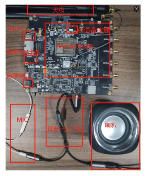
通过电源口,连接 12v 电源适配器,并插好 SIM 卡,接好天线以及相关线材。
